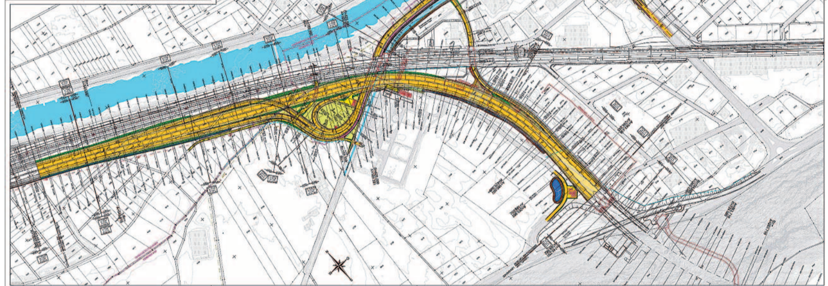
Vollanschluss Visp West. Die drei Kernelemente betreffen die Zu- und Abfahrtsstrassen bei der Grosseya (links) sowie die beiden neuen Brücken über die Vispa und den Rotten.
